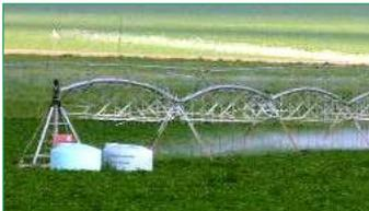
Cierre o tape las primeras boquillas para evitar la contaminación química del lugar de la inyección.
